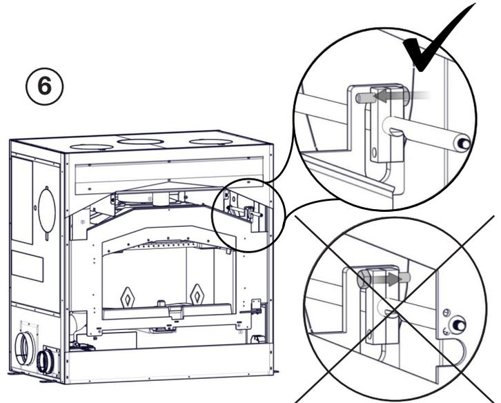
Installez un vis dedans le trou supérieure de les blocs de bouchon.
