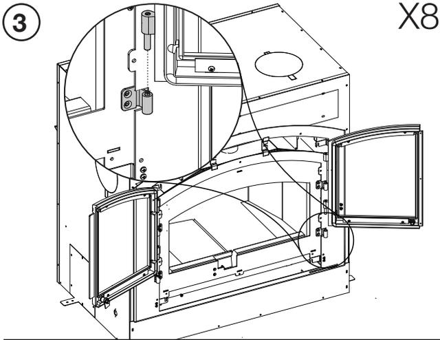
Ouvrez chaque portes et enlevez-les par relâchant le vis de blocage sur les charnières et soulevant vers le haut jusqu'à ce que les goupilles de charnière sont dégagés. Mettez au côté.
