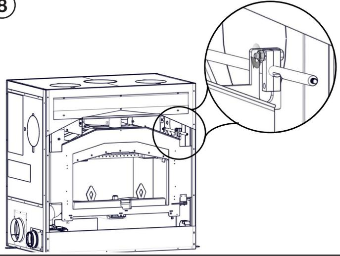
Installez un écrou hexagonale puis serrez-le à la main pour tenir les blocs de bouchon en place. Répétez pour le vis inférieur, la rondelle de blocage et l'autre écrou hexagonale.
