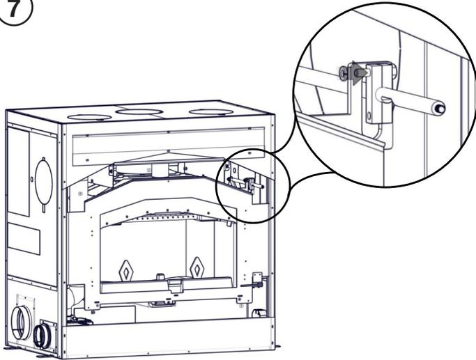
Installez une rondelle de blocage sur l'autre côté du vis supérieure.
