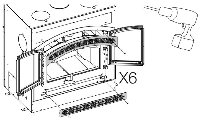
Enlevez les 4 vis fixant le panneau supérieur sur l'appareil. Enlevez les 2 vis fixant le panneau inférieur sur l'appareil.
