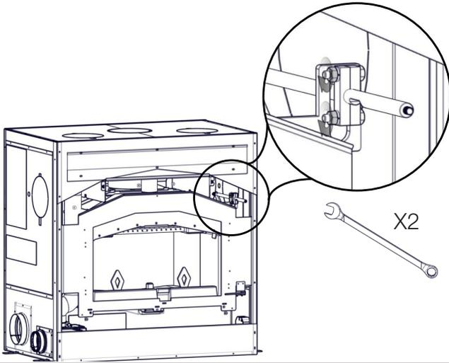
Serrez chaque écrou hexagonale jusqu'à ce que les blocs de bouchon sont complètement sécurisés autour le tige du dérivation. Assurez-vous que les blocs de bouchon ne bougent pas.
