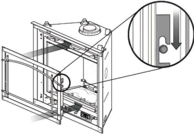
LIFT THE FRONT ASSEMBLY AND HOOK THE BRACKET OVER THE SHOULDER BOLTS.
