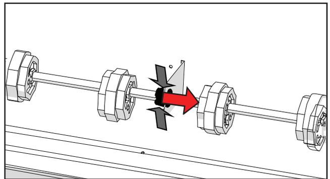
4. Retirez les douilles en les pinçant et en les poussant vers la droite. Retirez la tige de scintillement.
