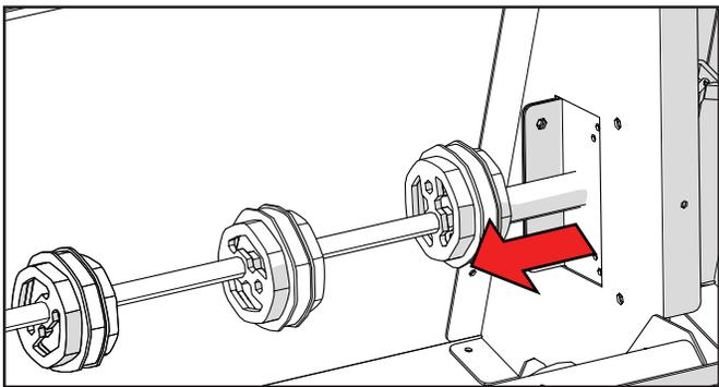
3. Retirez avec précaution la tige de scintillement du moteur de scintillement.
