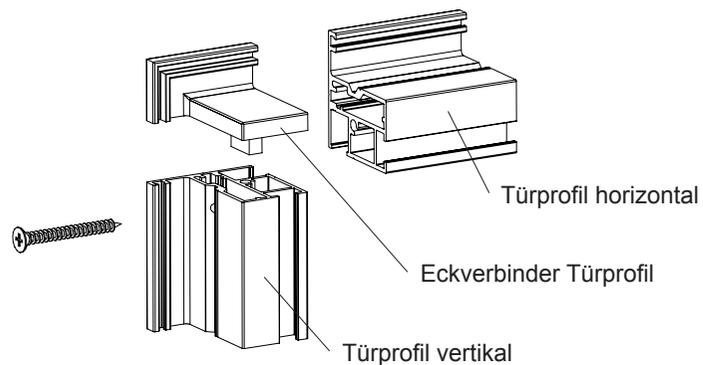
2 Zuerst den Eckverbinder in das vertikale Türprofil stecken.
