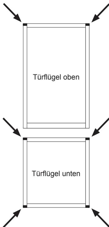
3 Anschliessend das horizontale Türprofil verschrauben.
