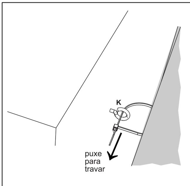
Aproxime a Cômoda da Parede pela sua parte traseira de forma a encaixar no GANCHO (K) já fixado na parede, a ABRAÇADEIRA (L) fixa no traseiro da cômoda. Depois, faça o aperto da ABRAÇADEIRA travando-a até que ela não se solte do GANCHO.
