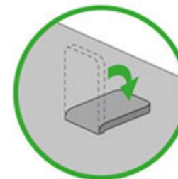
Bend the eyelet 90° / Загнути вушко на 90° / Zagnij oczko o 90° / Piegaie l'occhiello di 90° / Biegen Sie die Öse um 90° / Pliez l'œillet à 90° / Doble el ojal 90° / Dobre o ilhó em 90° / Загнути вушко на 90° / 将孔眼弯曲 90° / 구멍을 90° 구부립니다 / アイレットを90度曲げます。 / ביפוף הלוע 90 מעלות / ثني العينه 90 درجة
