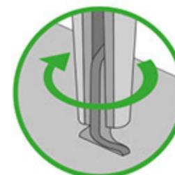
Twist the eyelet 45° / Закрутити вушко на 45° / Przekreć oczko o 45° Ruotare l'occhiello di 45° / Öse um 45° drehen / Tournez l'œillet à 45° Gire el ojal 45° / Torça o ilhó 45° / Закрутити вушко на 45° / 将孔眼扭转 45° / 구멍을 45° 비틀십시오 / アイレットを45°ひねる / 45° סובב את העין / قم بلف العينه بزاوية 45 درجة
