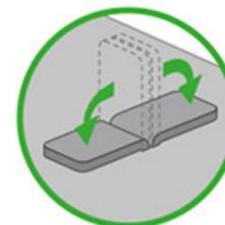
Bend the ears 90° / Розігнути вушка на 90° / Zegnij uszy o 90° / Piega le orecchie di 90° / Beuge die Ohren um 90° / Pliez les oreilles à 90° / Doble las orejas 90° Dobre as orelhas em 90° / Розогнуті вушки на 90° / 将耳朵弯曲 90° / 귀를 90° 구부립니다 / 耳を90度曲げます。 / ביפוף האוזניים 90 מעלות / ثني الأذنين 90 درجة
