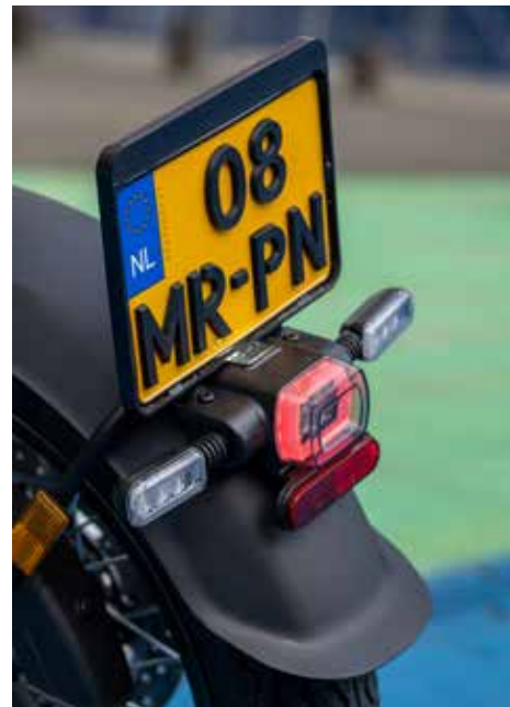
Het achterlicht is net als de knipperlichten achterop het spatbord geplaatst
