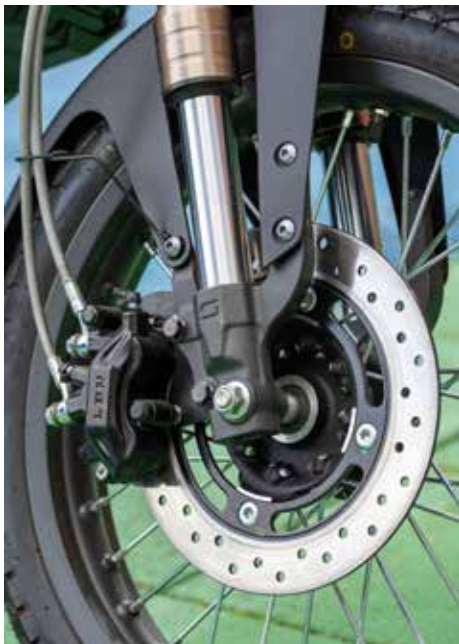
Fijne schijfrem die gekoppeld staat aan een gecombineerd remsysteem
