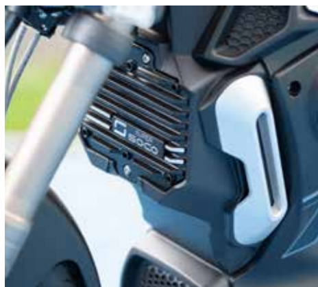
De controller krijgt de nodige rijwind achter het voorwiel
