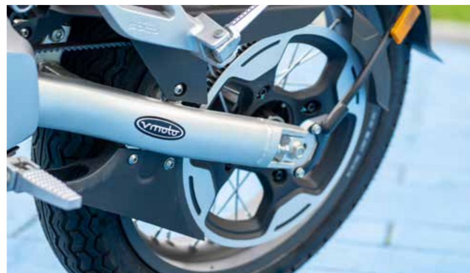
Het vermogen wordt richting het achterwiel gebracht middels een snaar
