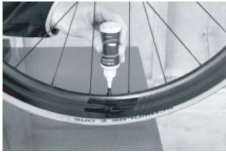
**7** バルブコアを外し、チューブレス用シーラントを適正量注入する（シーラントメーカー推奨量を遵守）
