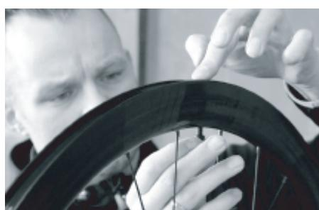
5 テープ側からバルブを押し込み、出口側から隙間を覆うように O リングをセットする
