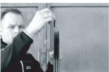
4 千枚通しなどを使用し、リムテープのバルブ穴中心位置に小さな穴を開ける
