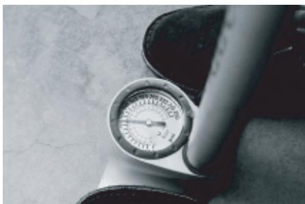
**10** タイヤに空気を充填する。リムの最大推奨空気圧は 8.3bar (120psi)
