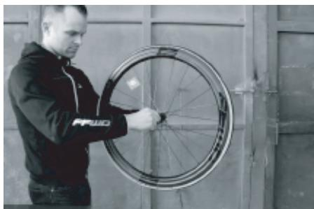
**9** 車輪をゆっくり回転させ、シーラントをタイヤ内部に満遍なく行き渡らせる
