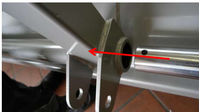
Abb.14 Justieren, ansetzen, einschieben
