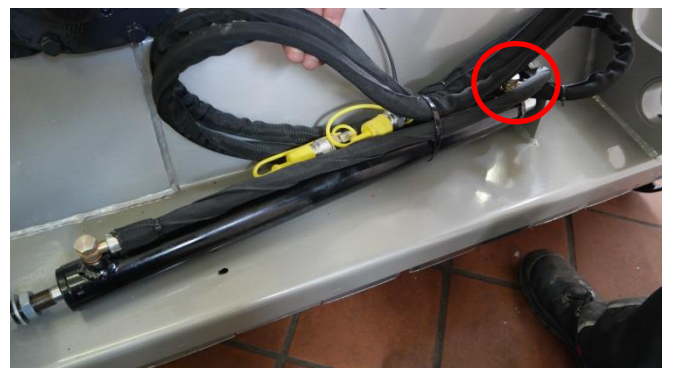
Abb.23 Hydraulikzylinder + Schlauch lösen
