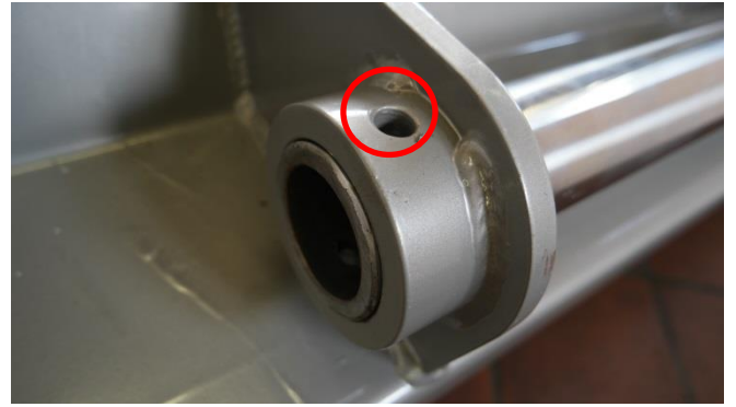
Abb.20 Schraube lösen links
