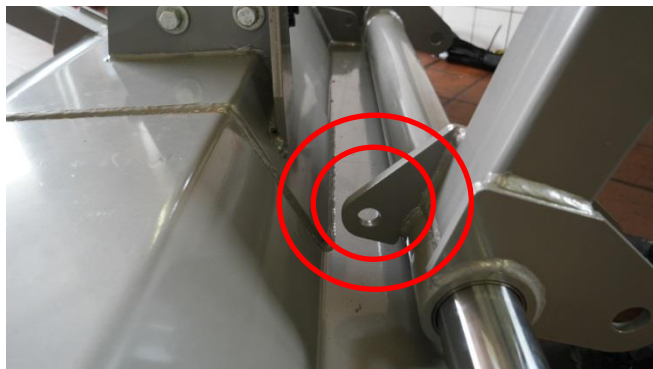
Abb.26 Bügel auf Gestänge mit Flansch
