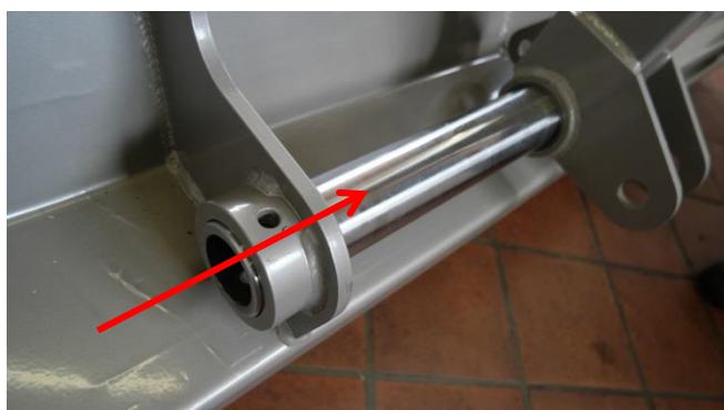
Abb.25 Bügel auf Gestänge aufgeschoben
