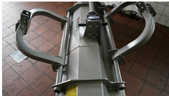
Abb.30 Bügel Frontaufnahme (links) und Heck (rechts)
