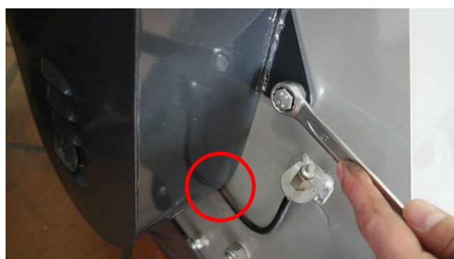
Abb.67 Verschrauben der Abdeckung
