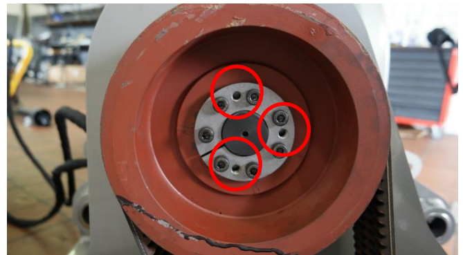
Abb.60 Bohrungen zur Korrektur
