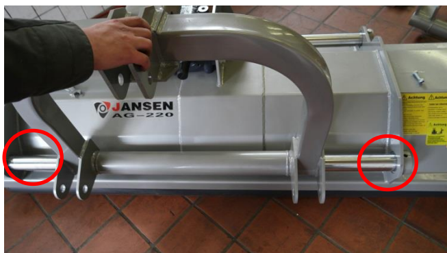
Abb.15 korrekt angesetzter Bügel
