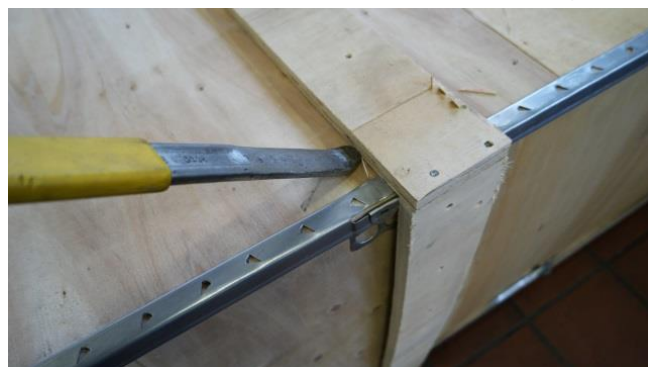
Abb. 2 Ansetzen des Hebels
