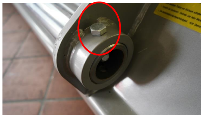
Abb. 9 Schraube rechts lösen
