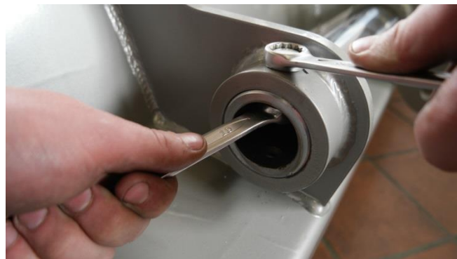
Abb.27 ausrichten, festschrauben links
