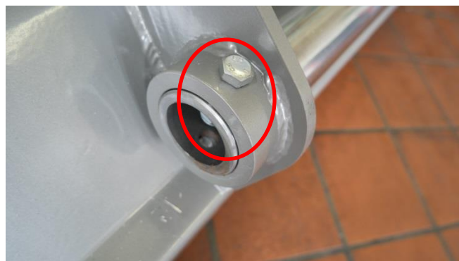
Abb.10 Schraube links lösen
