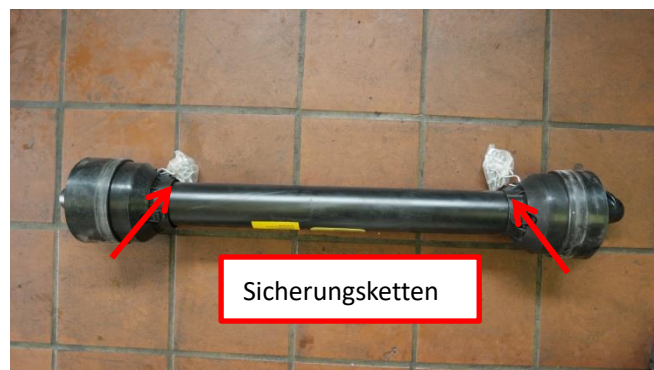
Abb.79 Zapfwelle mit Sicherungsketten
