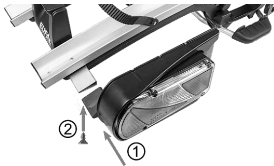
Figure 1 : Montage des feux arrière
