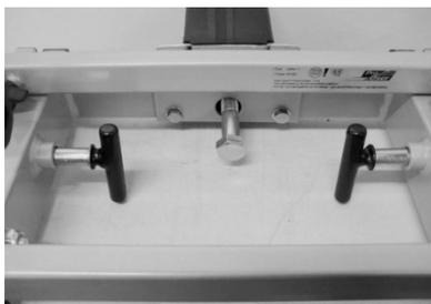
Basculer le cadre intérieur (tirer d'abord sur les deux boutons de sécurité, voir page 49), ainsi vous arriverez plus facilement à placer la plaque de fixation et à visser les écrous! Tourner la goupille de sécurité en position de blocage, dès que vous avez tourné la base. Ainsi vous évitez qu'il rebascule pendant votre montage.
