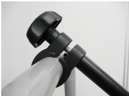
Pour pouvoir bien ouvrir la fermeture à pinces dévisser complètement le bouton en pvc. Placer d'abord la rondelle en pvc autour du tube-en-U et attacher à cet endroit la fermeture à pinces par dessus. Attacher ensuite à nouveau le support avec le bouton en pvc et fixer le sur le cadre de telle manière que les attaches-cadres puissent bouger légèrement (à cet endroit doivent être fixé les cadres du vélo). Les sangles servent à attacher le vélo.
