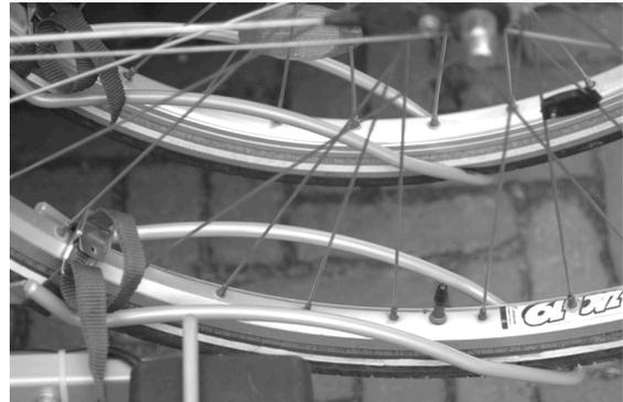
Attacher vous-même le vélo sur l'attache-vélo. L'attache-vélo est adaptable, il existe plusieurs positions. Il est important de placer l'attache-vélo le plus haut possible. Fixer le vélo par les sangles. Par ces sangles chaque vélo peut être fixé et le cadre du vélo ne subit aucune pression.
