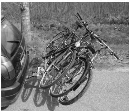
Pour remettre le porte-vélos dans sa position initiale, soulever le porte-vélos et repoussez les goupilles. Puis tournez les un quart de tour et faites en sorte que la goupille soit dans une position verticale, côté long vers le bas. Le clic montre que le verrouillage est en place.
