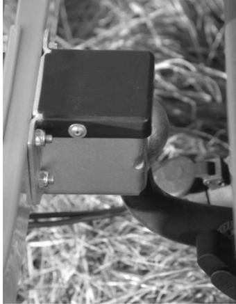
Monter le porte-vélos avec le raccordement sur l'attache-remorque. Vissez ensuite le gros boulon (M16x90) légèrement. Vérifier si le porte-vélos se trouve bien parallèle à votre voiture (ou pare-choc). Serrez bien le boulon avec la clé spéciale (ci inclus) en sorte que le porte vélos ne risque plus de bouger.
