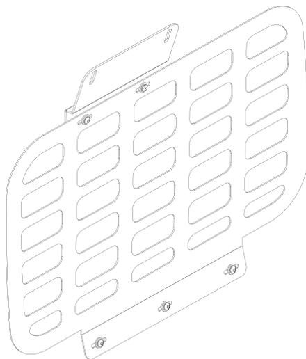
**1** El primer paso será desinstalar el sujetador que se encuentra arriba de las ventanas traseras. La tornillería que retire (propia del vehículo), será la utilizada para instalar en las ranuras superiores del organizador de ventana.
