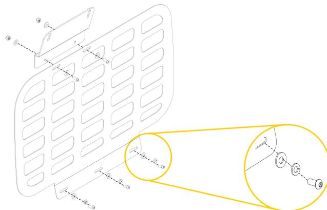
**2** Para los orificios de la parte de superior, coloque (1) tornillo allen M6 x 1 x 16mm, seguido de (1) arandela de presión 1/4", (1) arandela plana 1/4" y por la parte de atrás, (1) arandela plana 1/4" y (1) tuerca nylon.
