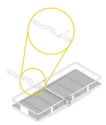
Para ajustar el portaequipajes a la posición vertical y plegada, retire el pasador y el clip. Levante el rack hasta que esté en posición vertical. Vuelva a insertar el pasador a través del receptor 2" y el orificio inferior del conjunto de la pieza correspondiente plegable.
