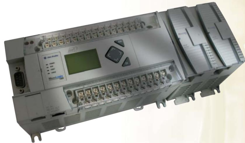
El MicroLogix 1400 de Rockwell Automation complementa la actual familia MicroLogix de controladores lógicos programables compactos, al combinar las funciones que usted exige en el MicroLogix 1100 tales como Ethernet/IP, edición en línea y pantalla de cristal líquido incorporada, además de características adicionales tales como más E/S, un contador de alta velocidad más rápido, y capacidades PTO y de comunicación.
