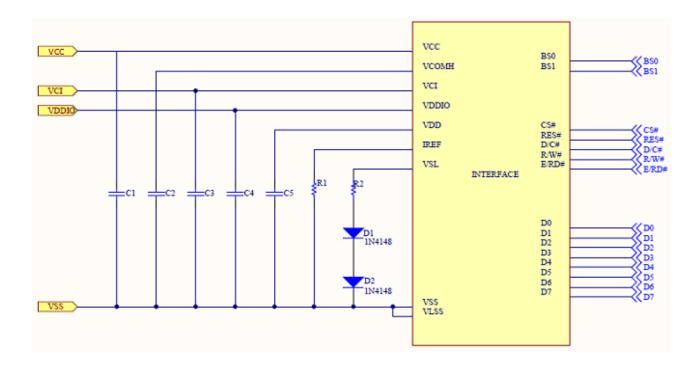
Recommended components : C3, C4, C5 : 1.0uF C1, C2 : 4.7uF D1, D2 : 1N4148, 0.7V R2 : 50ohm, 1/8W
