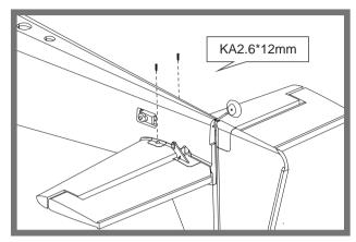
2.如图所示,安装舵机摇臂和连接杆。
