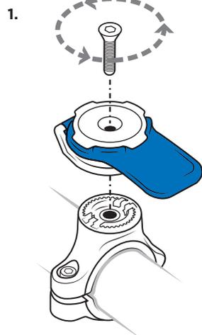
2. 本製品を取り付けます。その際、付属の M5x35mm スクリューを使用します。
