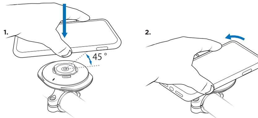
取り外し時 - 本製品自体を押し下げ、45° 回転させます。
