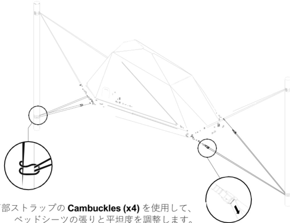
下部ストラップの **Cambuckles (x4)** を使用して、ベッドシーツの張りと平坦度を調整します。
