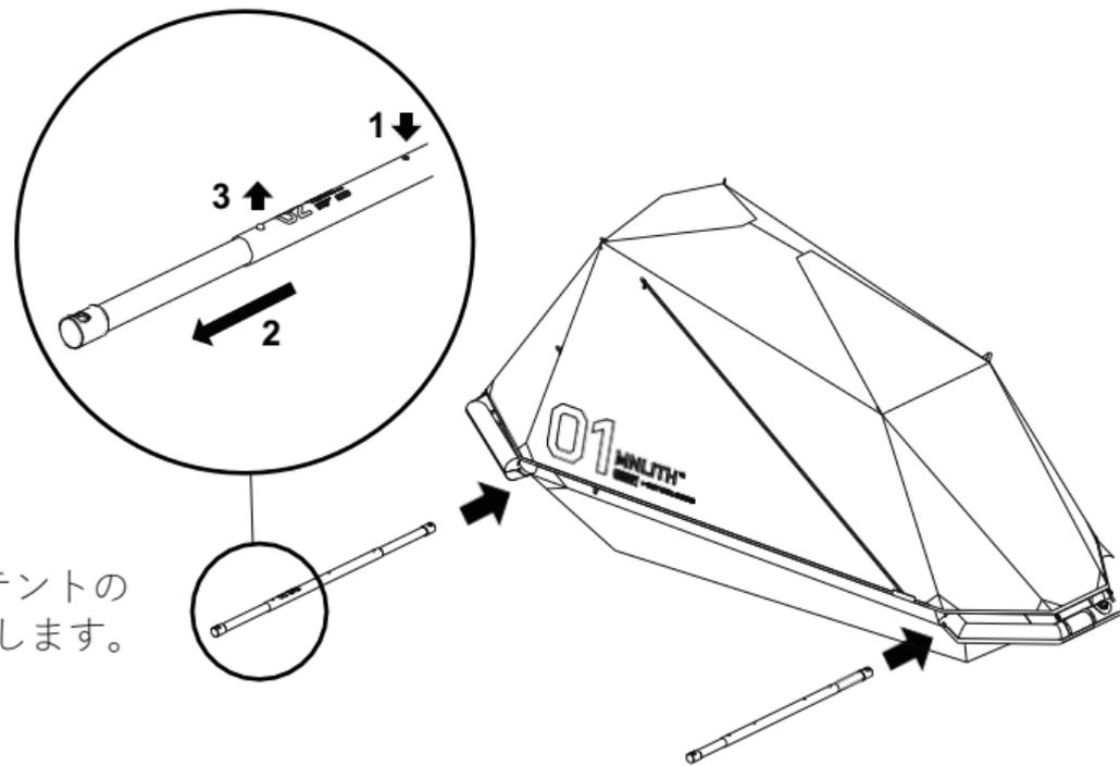
次に、対応する長さに応じて、ベッドの端にあるテントの裾に [PARALL] を挿入します。
