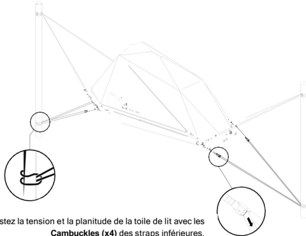
Ajustez la tension et la planitude de la toile de lit avec les **Cambuckles (x4)** des straps inférieures.
