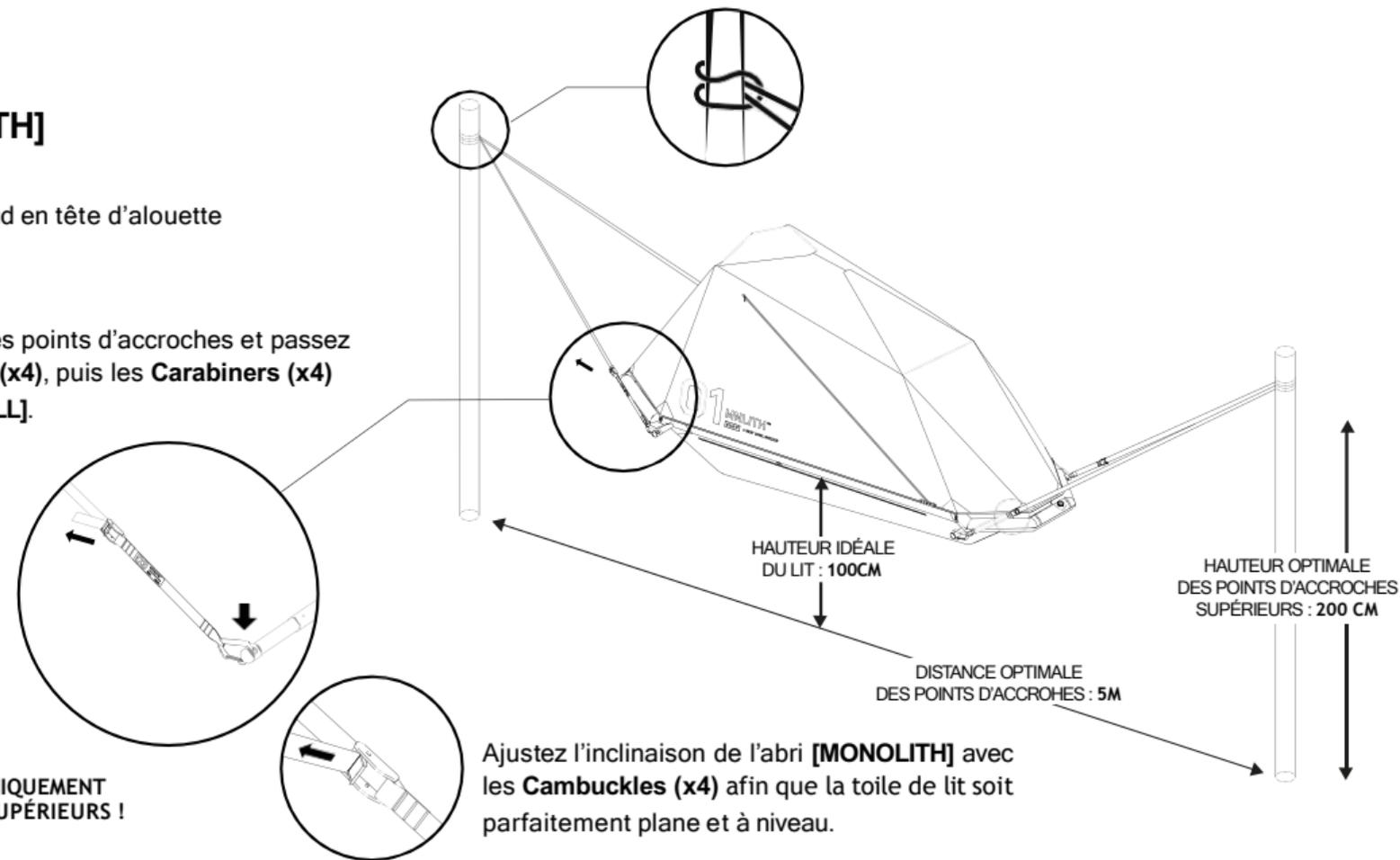
Ajustez l'inclinaison de l'abri [MONOLITH] avec les Cambuckles (x4) afin que la toile de lit soit parfaitement plane et à niveau.
