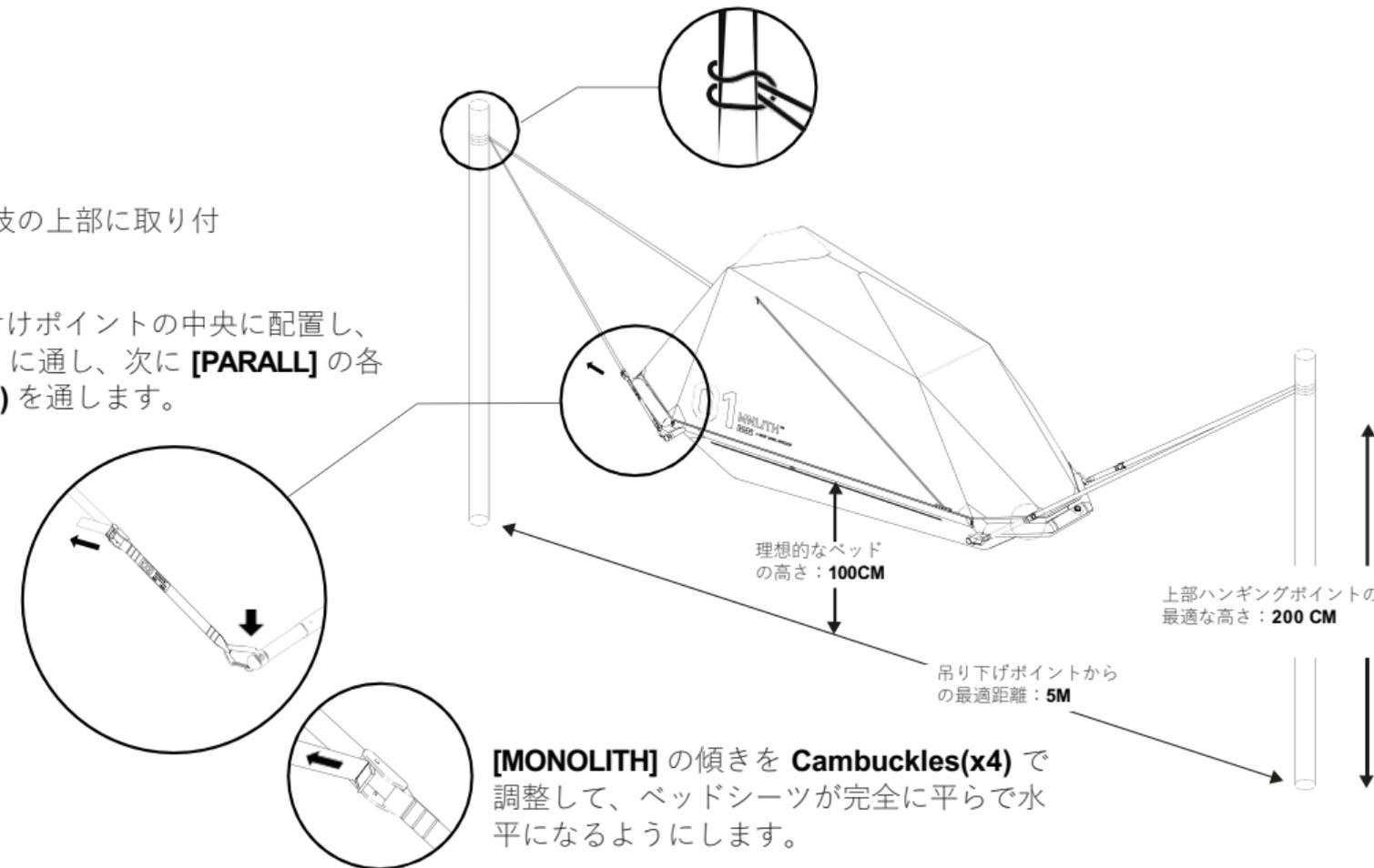
[MONOLITH] の傾きを Cambuckles(x4) で調整して、ベッドシートが完全に平らで水平になるようにします。
