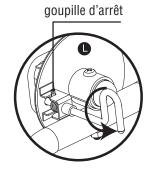
D Relâchez le guidon sur l'une des six positions de verrouillage pour engager le boulon à ressort.
