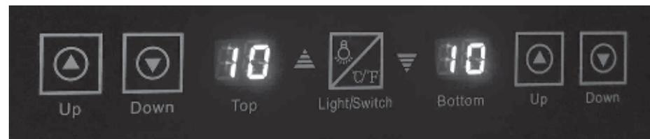
2. Réglez la température de refroidissement souhaitée en appuyant sur la touche ▲ ou ▼ à nouveau. Continuez d'appuyer sur les touches pour faire défiler les réglages de température disponibles. Les chiffres clignoteront lors du réglage. Les chiffres non clignotants indiquent la température interne actuelle en degré Celsius.
