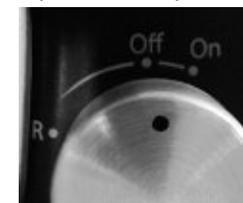
10. Si le bol de l'extracteur de jus est pris et ne se détache pas de la base, appuyez sur le commutateur de commande à la position « R » pendant 3 à 5 secondes. Répétez le processus 2 à 3 fois. Ensuite, soulevez le bol en le tournant.
