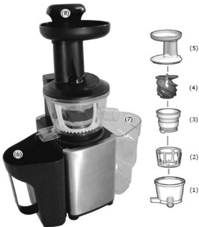
1. Placez le bol de l'extracteur (1) sur le dessus du corps principal en s'assurant que le bol s'enclenche dans le corps et ne peut pas être facilement retiré.
