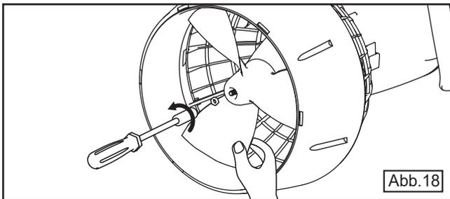
6. Ziehen Sie den Propeller von der Achse; passen Sie dabei auf, nicht den Führungsbolzen oder den Dichtungsring zu verlieren.
