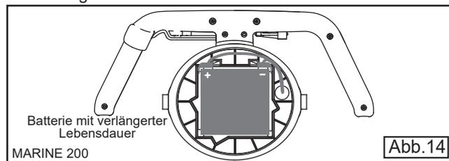
Die Batterie mit längerer Lebensdauer kann auf die gleiche Weise aufgeladen werden wie die Standardbatterie.
