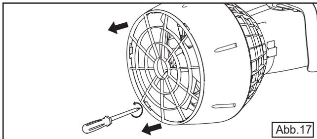
4. Lösen Sie die sechs Schrauben des hinteren Gitters, wie in Abbildung 17 dargestellt.
