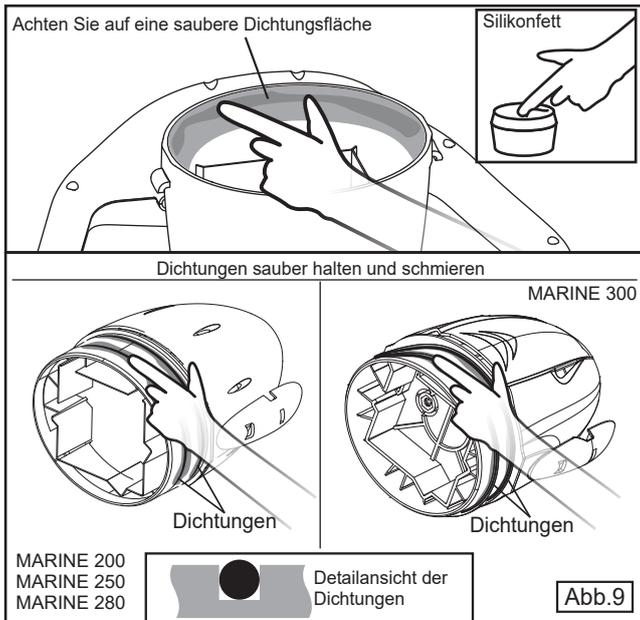
17. Stellen Sie sicher, dass der Verschluss sowie die Verschlussoberflächen sauber und geschmiert sind, bevor Sie diese wieder in die innere Bugnase einsetzen. Siehe Abbildung 9.
