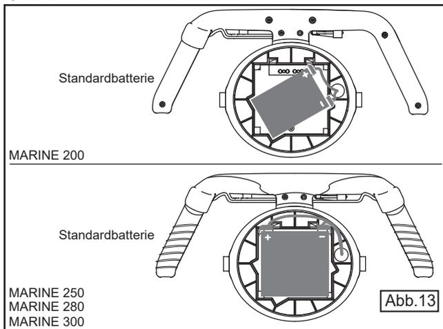
4. Installieren und verbinden Sie die aufgeladene Batterie an der richtigen Position – die Batterieleitungen müssen so platziert werden, wie es der Aufkleber auf der Batterie anzeigt, siehe Abbildung 13.
