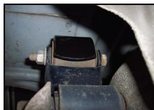
THE EYE BRACKET (**C1**) POSITIONED IN THE CENTER OF THE LEAF SPRING EYE.
