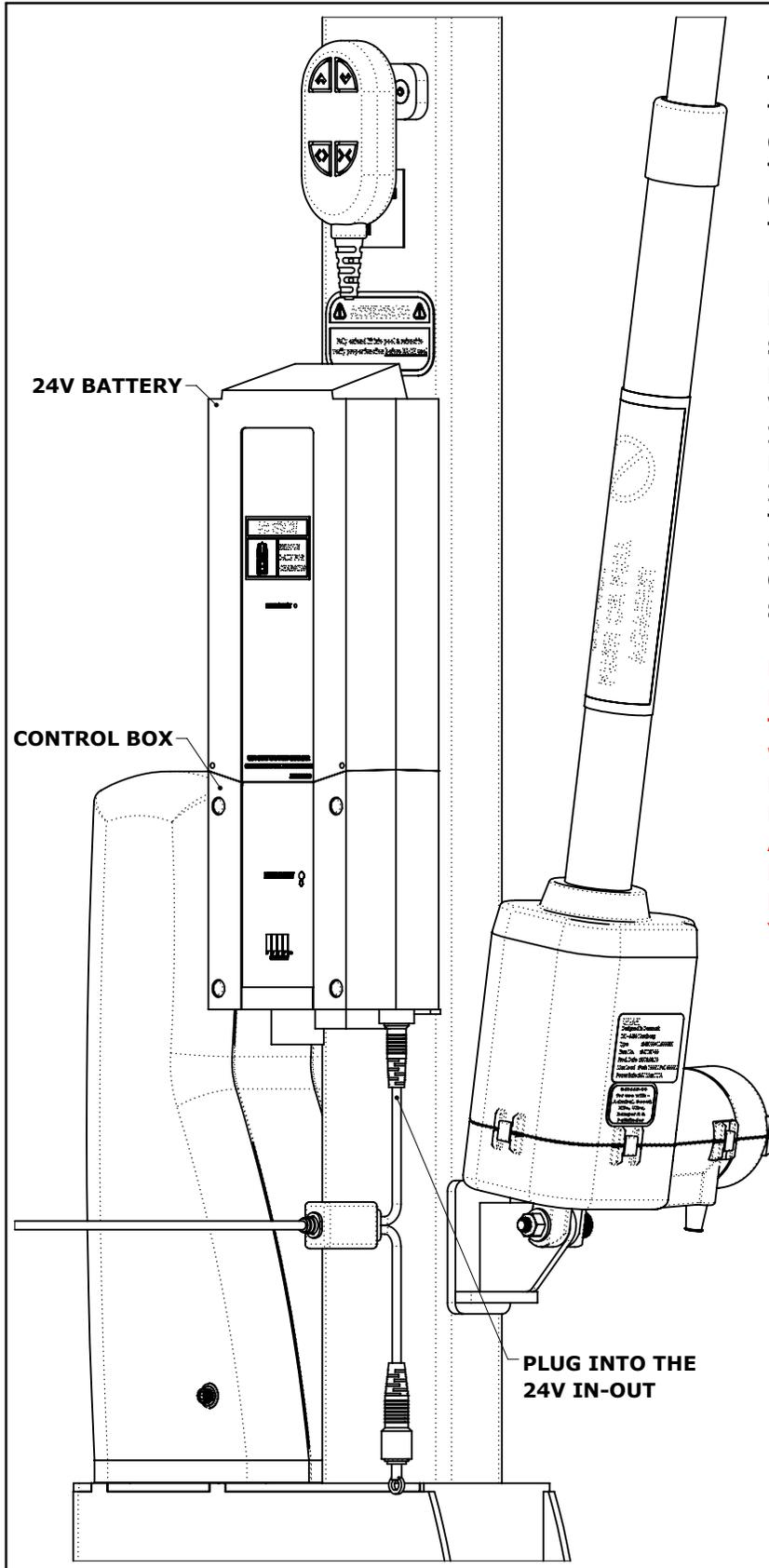
THE CHARGER CABLE GETS PLUGGED INTO THE 24V IN-OUT BOX WHICH IS LOCATED OPPOSITE OF THE ACTUATOR PLUG. RUN THE CABLE ALONG THE SIDE OF THE CONTROL BOX BRACKET SO IT IS OUT OF THE WAY.
