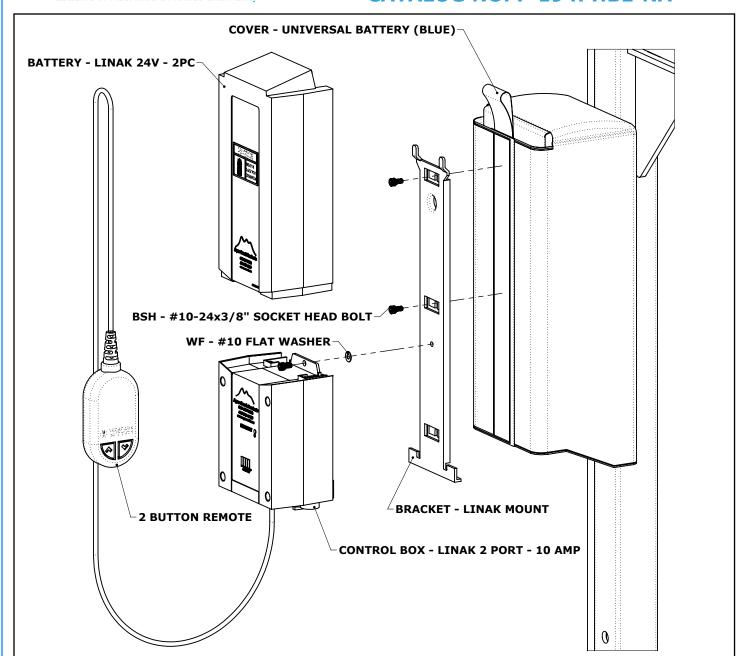
7 REMOVE THE FULLY CHARGED BATTERY FROM THE CHARGER AND INSTALL THE BATTERY TO THE CONTROL BRACKET, ON TOP OF THE CONTROL BOX. ONCE SECURE, CONNECT THE BATTERY CABLE TO THE CONTROL BOX CABLE. THE LIFT WILL ONLY OPERATE WHEN THE BATTERY IS CONNECTED PROPERLY.
