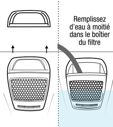
Remplissez d'eau à moitié dans le boîtier du filtre
