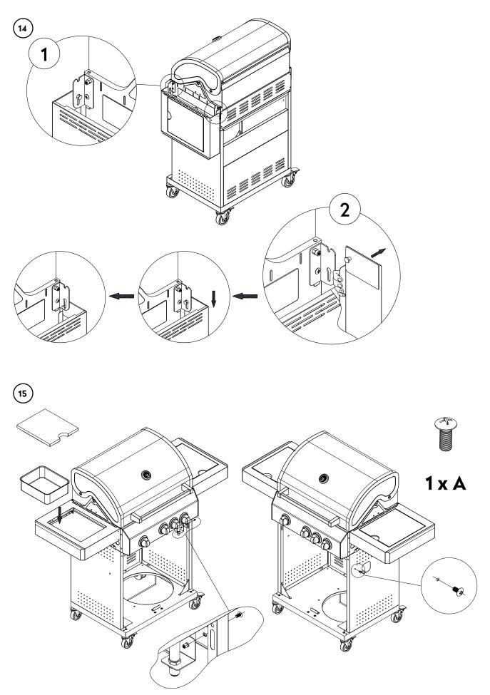
Der Gasanschluss ist für den Transport mit einem Kabelbinder unter der Konsole befestigt. Löse den Kabelbinder und schraube den Gasanschluss an die Seitenwand des Grills.
