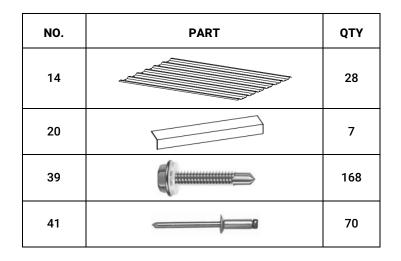
STEP 9 : INSTALL THE COLOR STEEL TILE OF THE FRONT DOOR.
