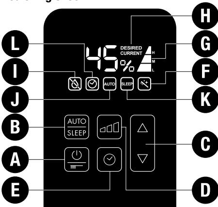
Bij het aanraken van toets A wordt het toestel in- resp. uitgeschakeld. Met behulp van toets A wordt ook de ont-kalkingsmodus gestart. Zie hoofdstuk "Ontkalkingsmodus" (18 – 25). Het toestel bevindt zich na het inschakelen in de AUTO-modus (symbolus J).
