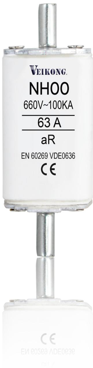
Los fusibles de fusión rápida tipo aR, también conocidos como fusibles de acción rápida para semiconductores, están diseñados para proteger dispositivos electrónicos y componentes sensibles, como semiconductores, en circuitos eléctricos. Estos fusibles tienen la capacidad de interrumpir rápidamente la corriente en caso de una sobrecarga o cortocircuito.
