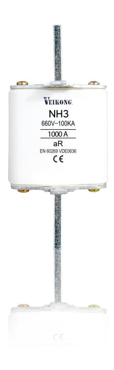
Los fusibles de fusión rápida tipo aR, también conocidos como fusibles de acción rápida para semiconductores, están diseñados para proteger dispositivos electrónicos y componentes sensibles, como semiconductores, en circuitos eléctricos. Estos fusibles tienen la capacidad de interrumpir rápidamente la corriente en caso de una sobrecarga o cortocircuito.
