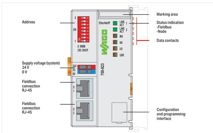
Este controlador puede utilizarse como controlador programable en redes de comunicación basadas en EtherNet/IP en combinación con WAGO I/O SYSTEM.
