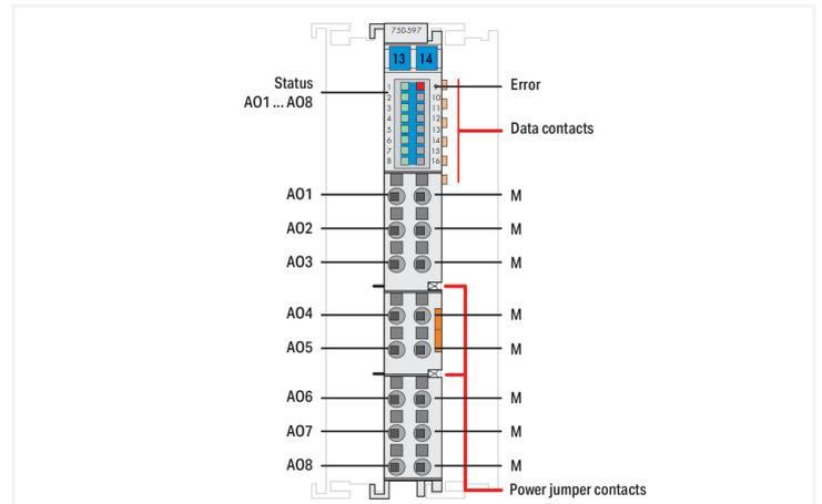
Este módulo de salida analógica genera señales de magnitudes estándar de 0–10 V y ±10 V. La señal de salida está aislada galvánicamente y se transmite con una resolución de 12 bits.
