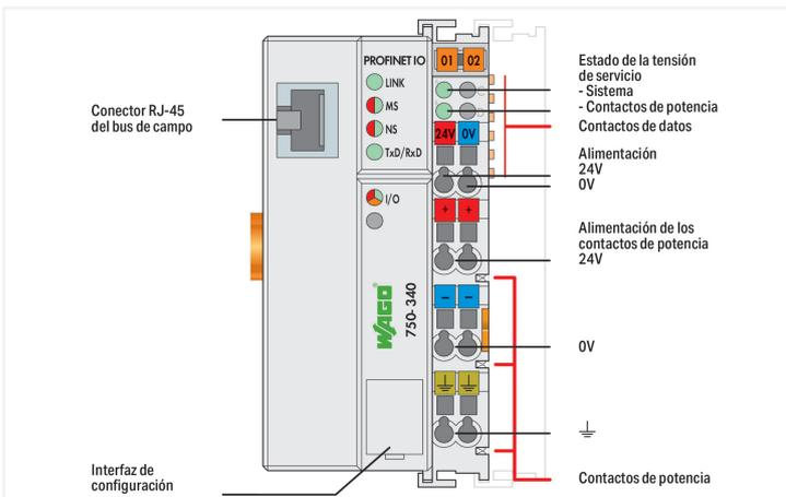
Este acoplador de bus de campo permite conectar el sistema modular WAGO I/O SYSTEM a PROFINET IO, la norma de automatización abierta de ETHERNET industrial.
