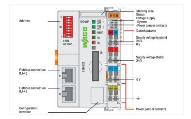
El acoplador de bus de campo BACnet/IP 750-332 permite la conexión de los módulos WAGO I/O SYSTEM con el protocolo BACnet y es compatible con el perfil de dispositivo B-BC BACnet de acuerdo con DIN EN ISO 16484-5.
