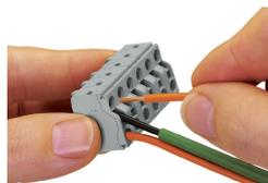
La conexión Push-in CAGE CLAMP® incorpora una apertura sencilla, rápida e idéntica a la CLEMA CEPO (CAGE CLAMP®). El destornillador se inserta completamente en la apertura de accionamiento y mantiene la conexión Push-in CAGE CLAMP® abierta. Una vez insertado el conductor en el punto de conexión y retirado el destornillador, el conductor queda fijado de forma segura. Permite conectar conductores rígidos y flexibles de <math><0,5 \text{ mm}^2</math> con la ayuda de un destornillador.
