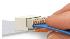
Tire de la herramienta de desbloqueo y de los conductores para extraer el conector hembra del conector macho.
