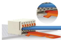
Desconexión de conector hembra con herramienta de desbloqueo. Inserte la herramienta de desbloqueo en el clip de enganche del conector macho.
