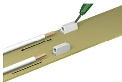
Inserte conductores flexibles y extraiga cualquier tipo de conductor con la herramienta de accionamiento. Los conductores rígidos también se pueden conectar insertándolos simplemente en la unidad.
