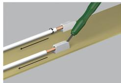
Utilice una herramienta de accionamiento o simplemente gire los conductores rígidos y tire de ellos para extraerlos.
