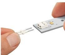
Inserción de un elemento de conexión en la borna.
