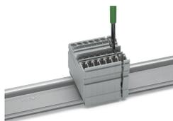
Para separar las bornas, deslice lateralmente una borna con la herramienta de accionamiento (3,5 x 0,5 mm de hoja).
