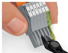
Codificación de un conector hembra: extraiga el tetón codificador con una herramienta adecuada.
