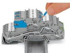
Inserción de un conductor a través de la conexión enchufable. Se pueden enchufar conductores rígidos de una sección por encima y hasta dos secciones por debajo de la sección nominal fácilmente sin necesidad de utilizar herramientas.
