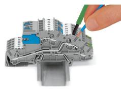
Inserción de conductor con herramienta de accionamiento. La conexión de conductores flexibles sin punteras, o conductores de secciones pequeñas que no se pueden insertar, se realiza de forma similar a la CLEMA CEPO (CAGE CLAMP®) original, solo requiere el uso de una herramienta de accionamiento.
