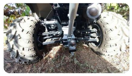
La barra ha sido diseñado para ayudar a prevenir al conductor de quedar atrapado en volcamientos laterales y hacia atrás que pueden tener desenlaces con heridas graves o fatales.
