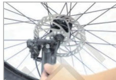
Przełóż oś przelotową przez przedni widelec i przednie koło
