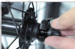
Obie strony muszą być dokręcone, podciągnij blokadę zabezpieczającą
