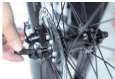
Dokręć śrubę osi przelotowej
