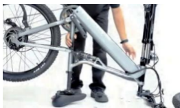
Poluzuj śrubę osi przelotowej
