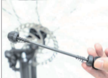
Zamontuj przednie koło w widelcu
