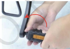
Instalado do outro lado
