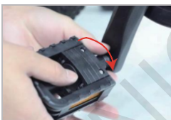
Instalado no lado do pedaleiro
