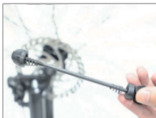
Installez la roue avant dans la fourche
