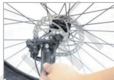
Passez l'axe traversant à travers la fourche avant et la roue avant
