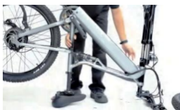
Desserrez la vis de l'axe
