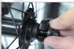
Les deux côtés doivent être serrés, tirez le verrou de sécurité
