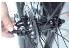
Apriete el tornillo del eje pasante
