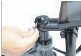
Befestigen Sie anschließend die beiden Schrauben an der Seite des Vorbaus
