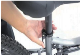
Passen Sie Höhe und Richtung an und verriegeln Sie die Schnalle
