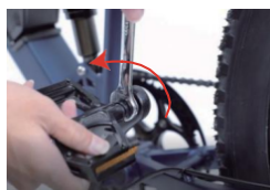
Zum Festziehen gegen den Uhrzeigersinn drehen
