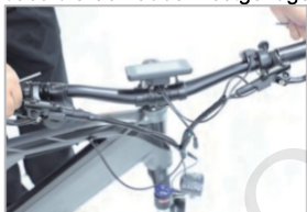
Setzen Sie den Lenker auf den Vorbau
