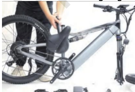
Öffnen Sie die Schnalle und stecken Sie den Sattelvorbau in
