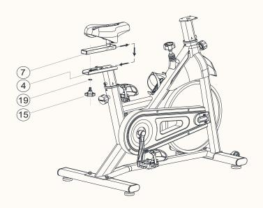
**4.** Faites glisser le réglage de la selle (7) sur la tige de la selle (4). Puis fixez-le avec une rondelle plate (19) et un bouton de réglage (15).
